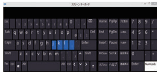
Windowsの「スクリーンキーボード」のスキャン機能を使えば、スイッチからの1つの信号でも文字入力が可能
