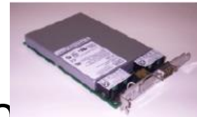
IBM 4764 PCI-X Cryptographic Coprocesor
